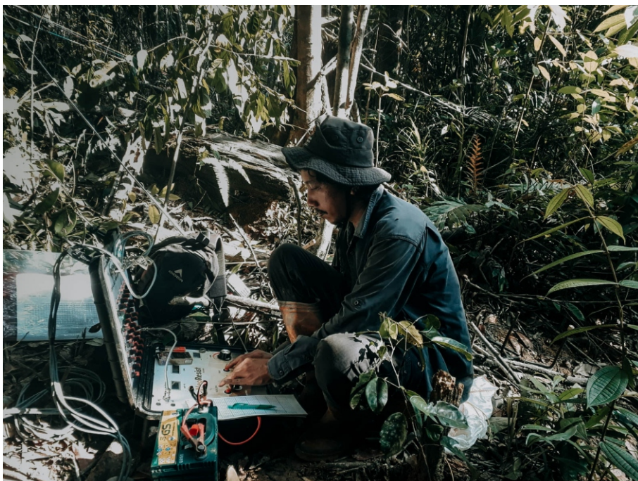
Proses akuisisi data geolistrik
